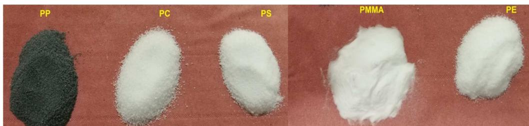
Figure II.1. Photographie des particules de PP, PC, PS, PMMA et PE.
