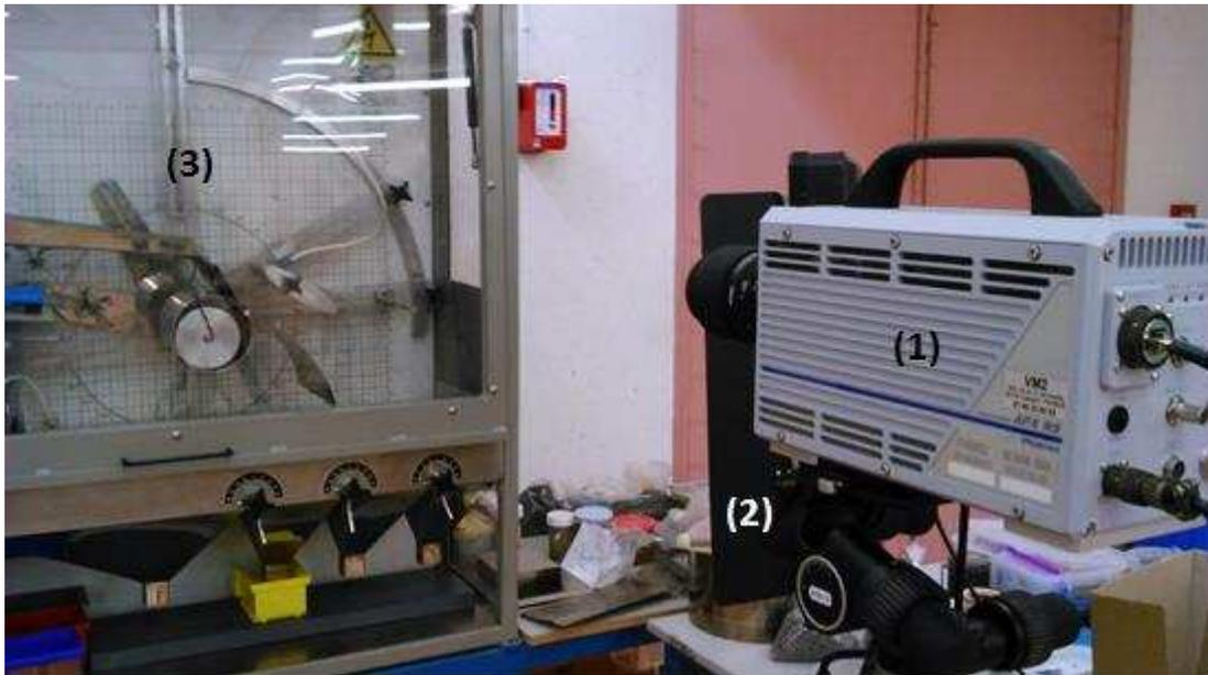
Figure II-21 : Caméra rapide utilisée pour la visualisation de particules dans un séparateur électrostatique à plaque. (1) Caméra rapide ; (2) Spot lumineux ; (3) Séparateur électrostatique à plaque.
