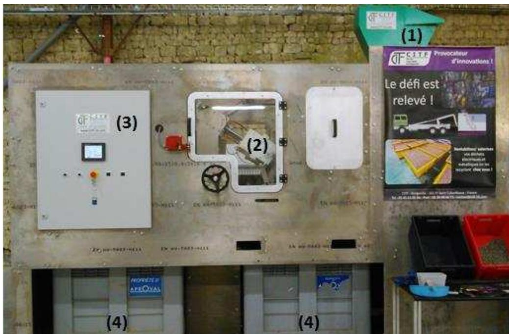
Figure II-7 : Prototype de séparateur électrostatique industriel PRD (voir Vue 3D présentée en annexe I). (1) Broyeur ; (2) Système d'électrodes ; (3) Armoire électrique avec écran tactile ; (4) Caisses-palettes.
