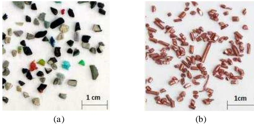
Figure I-18 : Granules de plastique (a) et de cuivre (b) de déchets de câbles électriques rigides.
