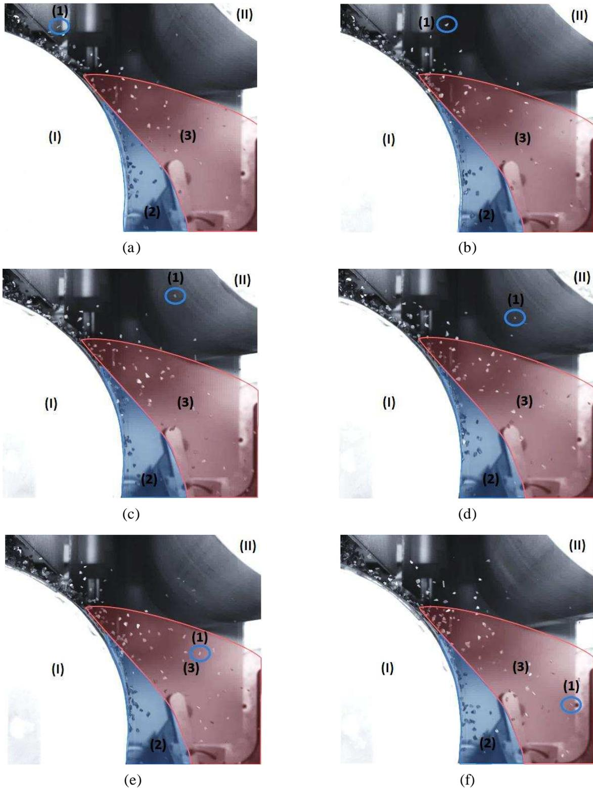
Figure V-16 : Trajectoires des particules visualisées par la caméra rapide à différents instants. (I) Electrode cylindrique tournante reliée à une source de haute tension négative ; (II) Electrode cylindrique tournante reliée à une source de haute tension de polarité positive ; (1) Particule de PVC impactant l'électrode supérieure ; (2) Zone de déplacement des particules de HIPS ; (3) Zone de déplacement de la majorité des particules de PVC.
