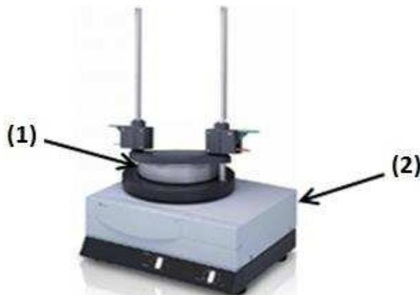
Figure II-16 : Dispositif de charge triboélectrique. (1) Boîte en acier inoxydable ( $\phi = 160$  mm) ; (2) Dispositif vibrant (Retsch).
