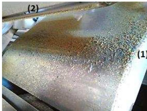
Figure II-9 : Electrodes encrassées après quelques minutes de fonctionnement. (1) Electrode plaque en forme de « S » ; (2) Electrode semi-elliptique.
