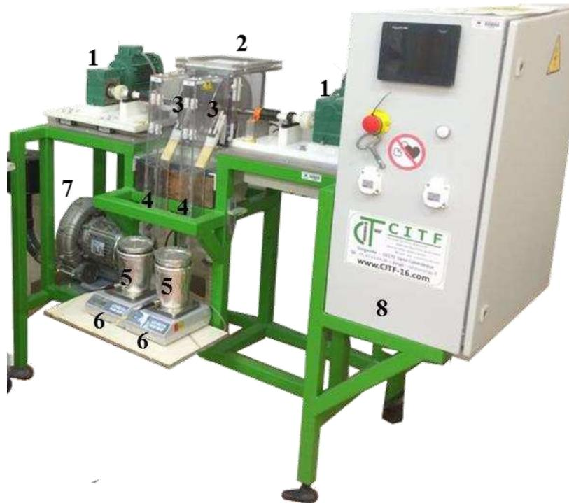
Figure I-40 : Photographie d'un séparateur tribo-aéro-électrostatique à disques [151]. (1) Moteurs électriques ; (2) Chambre de séparation ; (3) Electrodes-disques tournants ; (4) Collecteurs ; (5) Cages de Faraday ; (6) Balances électroniques ; (7) Turbine ; (8) Armoire électrique.
