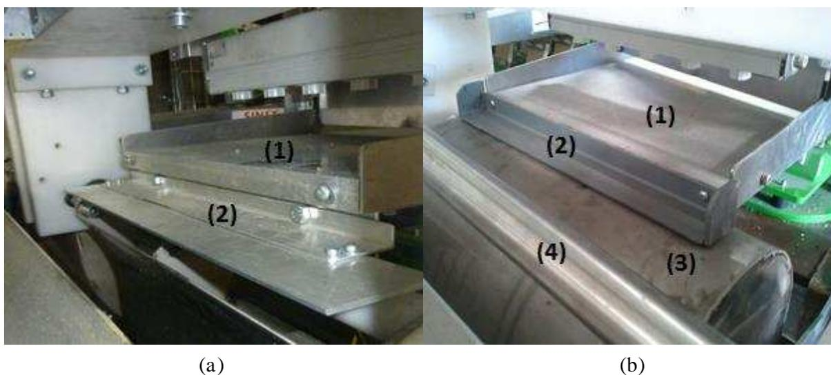
Figure III-13 : (a) Equerre initiale ; (b) Nouvelle équerre placée en bout de table vibrante. (1) Table vibrante ; (2) Equerre ; (3) Electrode cylindrique tournante ; (4) Electrode couronne.
