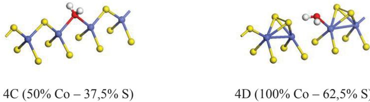
**Figure III-53** : Configurations d'adsorption de H<sub>2</sub>O sur le bord S du catalyseur CoMoS
